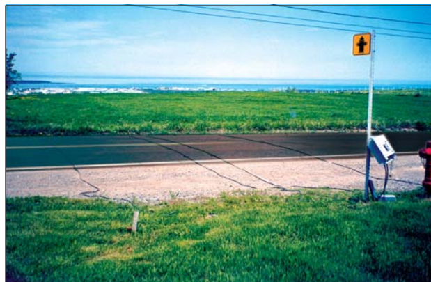
Installation pour un relevé automatique en section (court terme) Source: Ministère des Transports du Québec (B. Bussière)
