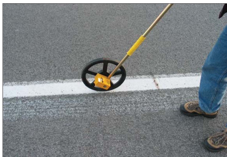
Mesure de visibilité à l'aide d'une roue à mesurer
