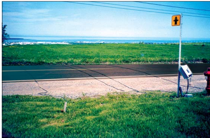
Mesures de vitesses à l'aide de tubes
