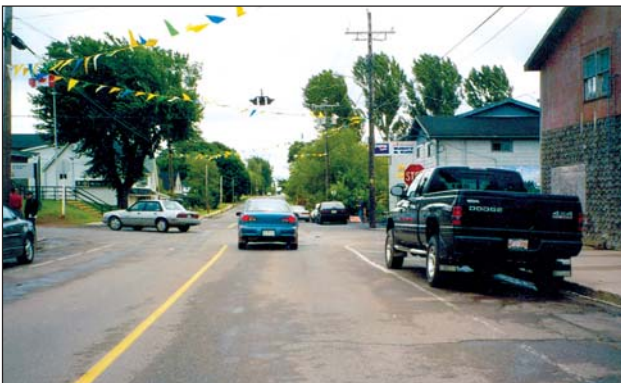
Panneau d'arrêt dissimulé par un véhicule stationné. Les conducteurs ne connaissant pas l'endroit ne peuvent savoir qu'ils doivent arrêter.
