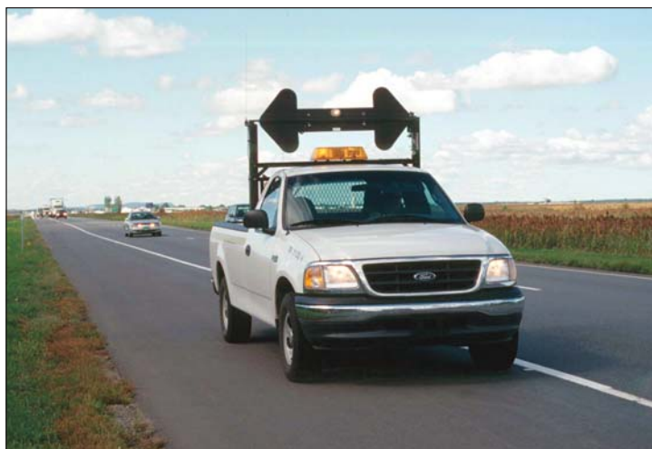
Inspection routière à vitesse réduite à l'aide d'un véhicule de patrouille.
